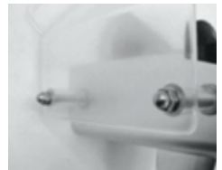
4. Die beiden Kapselmutter anziehen.
