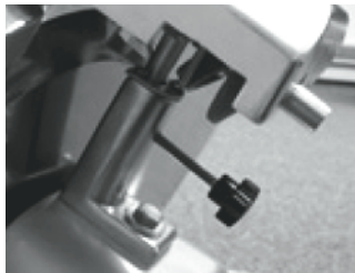
3. Zaciśnij uchwyt, aby ostrzatka pozostała nieruchomo na miejscu. Przed użyciem urządzenia upewnij się, że ostrzatka jest stabilnie zamontowana.
